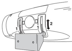
Il dispositivo di comando può essere ruotato nel supporto a parete e l'inclinazione può essere adattata. Un blocco impedisce al dispositivo di comando ruotato di staccarsi dal supporto a parete.
