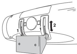
Element obsługowy można przechylać na uchwyty ściennym i w ten sposób dopasowywać pochylecie. Blokada uniemożliwia zdejmowanie elementu obsługowego z uchwyty ściennego w stanie pochylonym.
