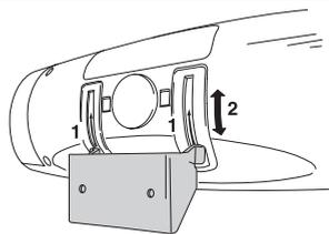
**i** Перед снятием блока управления с кронштейна поверните его полностью вперед!
