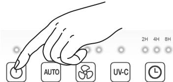
1. Hava temizleyiciyi kapatmak için Açıma/Kapama düğmesine basın ve fişini prizden çekin.
