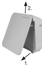
2. Retirez le couvercle du boîtier comme indiqué (fermeture magnétique). Décrochez d'abord la fermeture magnétique en bas, puis en haut.
