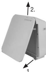
2. Nehmen Sie die Gehäuseabdeckung wie abgebildet ab (Magnetverschluss). Hängen Sie den Magnetverschluss zuerst unten und anschließend oben aus.
