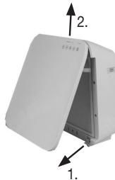
2. Cihaz kapağını şekilde gösterildiği gibi çıkarın (mıknatıslı kilit). Mıknatıslı kilidi önce alttan ve sonra üstten yerinden çıkarın.
