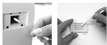
Trocknen Sie danach alle gereinigten Teile mit einem trockenen Wattestäbchen.
