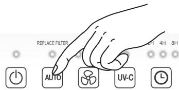
6. Stecken Sie den Netzstecker in die Steckdose. Verlegen Sie das Kabel stolpersicher. Halten Sie die AUTO-Taste (**AUTO**) für fünf Sekunden gedrückt. Der Betriebsstundenzähler ist nun wieder auf 0 zurückgestellt.
