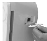
Pulire il sensore nonché l'ingresso e l'uscita dell'aria con un cotton fioc umido.
