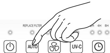
6. Conecte el conector de red a la toma de corriente. Coloque el cable de forma que no se pueda tropezar con él. Mantenga pulsado el botón AUTO ( durante 5 segundos. El contador de horas de funcionamiento se ha vuelto a reponer a 0.
